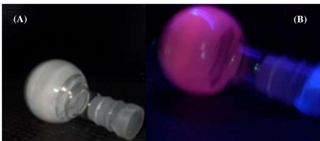
**Figura 18**-Sílica funcionalizada com TTA e coordenada ao íon Eu (III), antes (A) e depois (B) de irradiada com lâmpada de UV.
