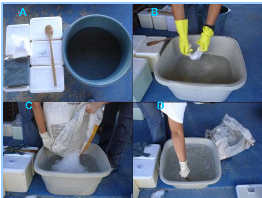
Figura 5: Preparo da solução com metabissulfito de sódio: A – Material utilizado para cada tratamento; B – Adição do metabissulfito de sódio em 12,5L de água doce; C – Adição do gelo a água doce com metabissulfito de sódio; D – Homogeneização da solução.
