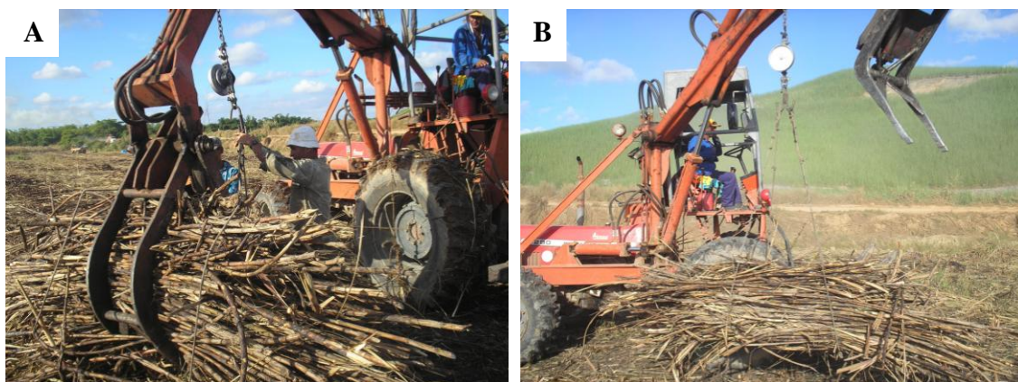
Figura 8. A - Pesagem do feixe em campo, B - Dinamômetro acoplado ao braço mecânico da carregadora.
