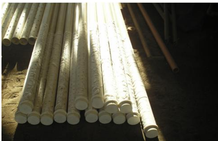
Figura 4. Tubos de PVC perfurados e recobertos com tela filtrante
