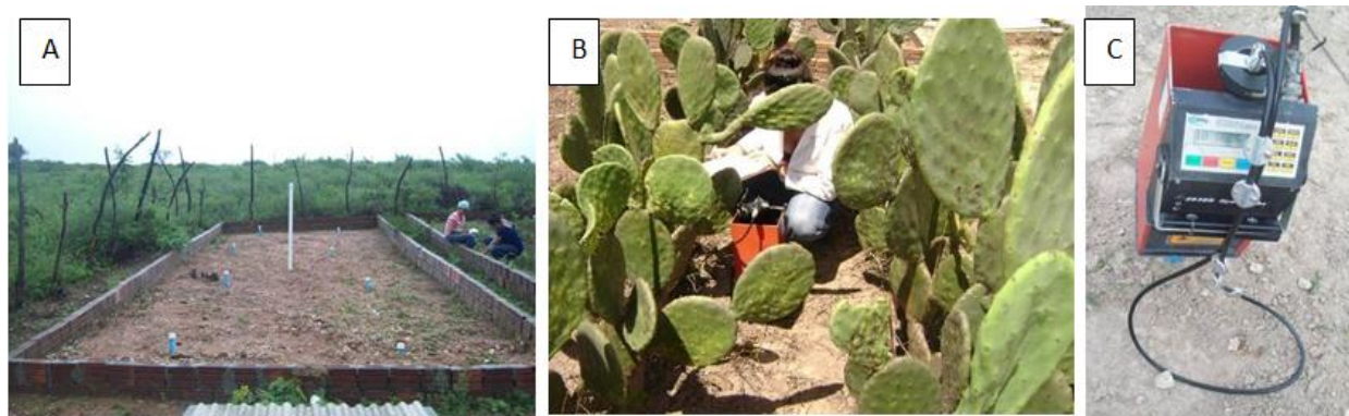
Figura 6. Área experimental. A. Tubos de acesso. B. Monitoramento da umidade do solo com a sonda de nêutrons. C. Sonda de Nêutrons.
