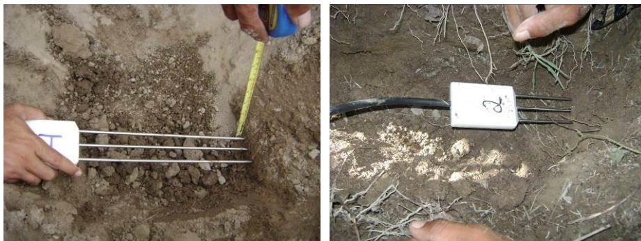
Figura 1. Instalação das sondas TDR's nas parcelas experimentais.
