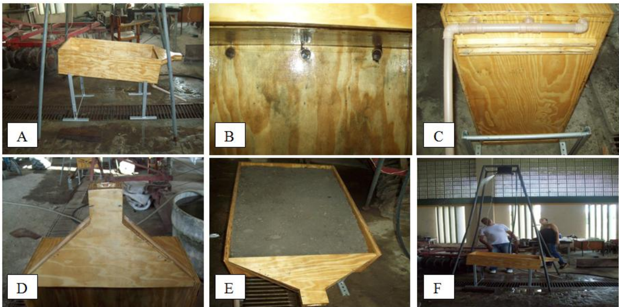
Figura 1. Detalhes da parcela experimental. A - Parte lateral, B- Drenos na parte interior, C- Dreno coletor na parte inferior, D – Calha coletora na parte superior, E – Vista superior, F – Parcela com o simulador.
