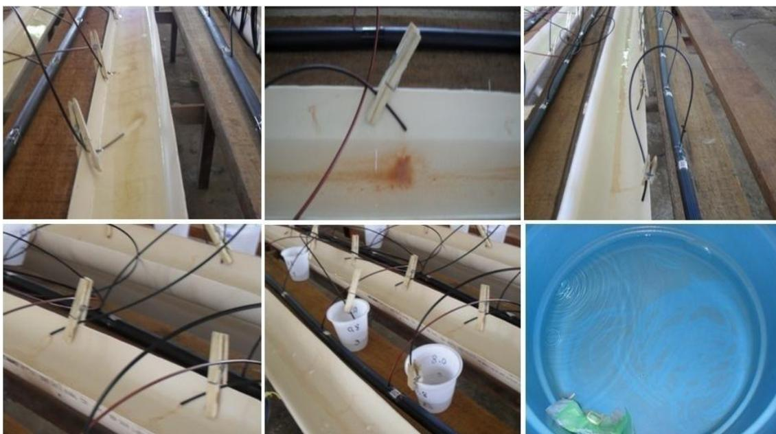
**Figura 6.** Indícios visuais da precipitação do ferro na água de irrigação
