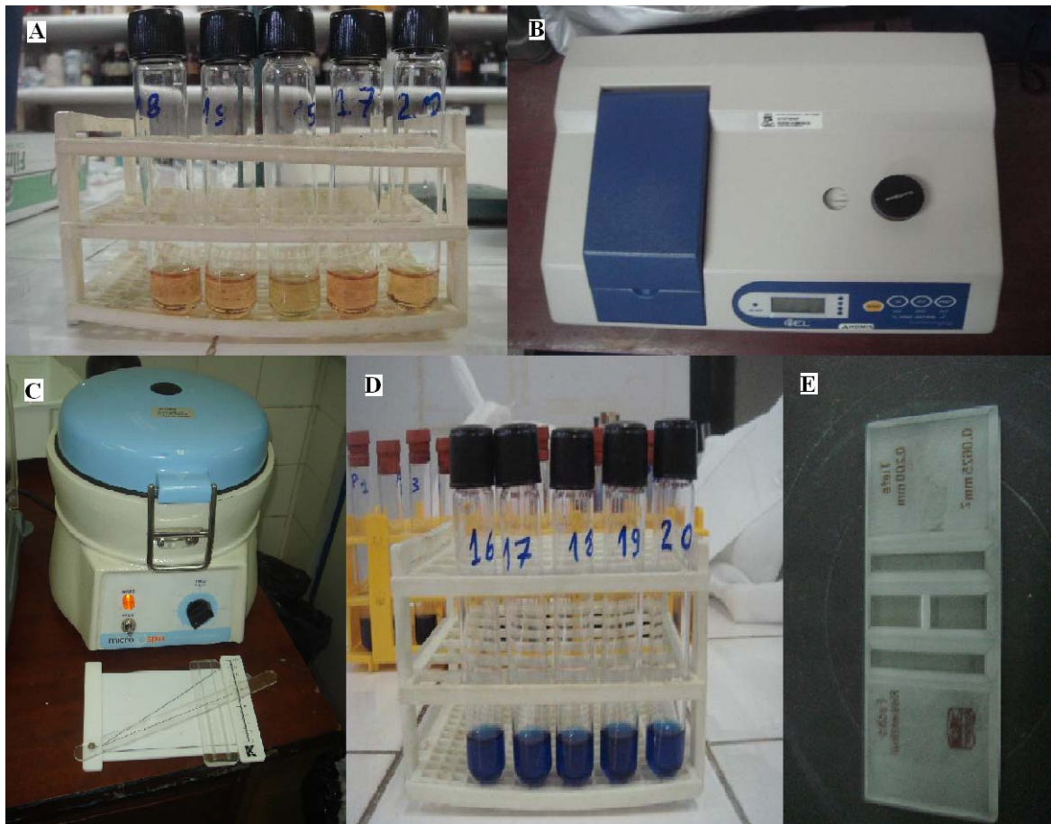
Figura 3: A) Sangue em solução de Drabkin; B) espectrofotômetro; C) micro-centrífuga; D) sangue em solução de formol-citrato; E) câmara de Neubauer.
