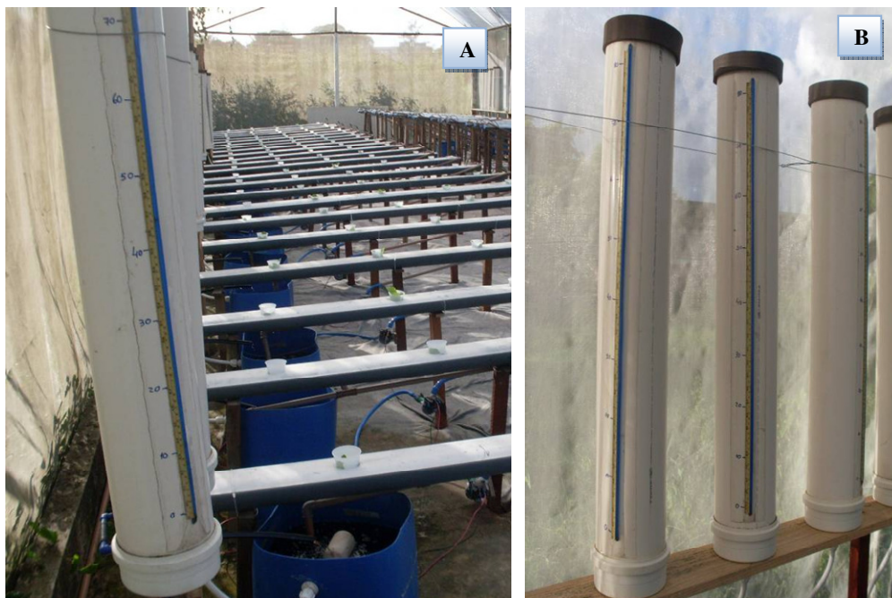
Figura 4. Abastecedor automático interligado a uma torneira bóia (A) e (B) abastecedores devidamente tampados
