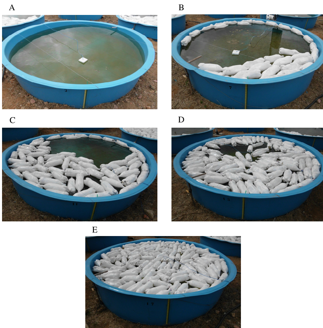
Figura 8. Coberturas de 0% (A), 20% (B), 40% (C), 60% (D) e 80% (E) da área superficial do espelho d'água coberta com garrafas PET
