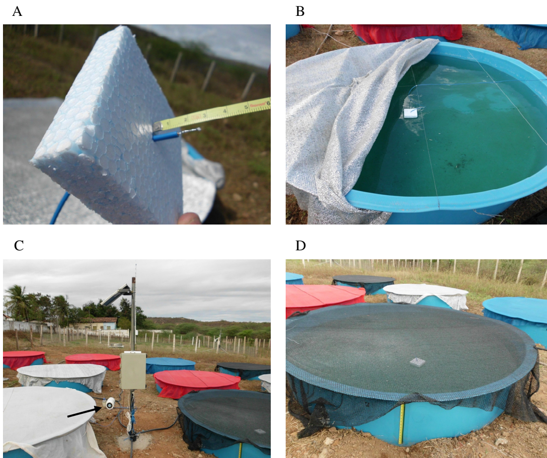
Figura 2. Termopar (A), posicionamento do termopar nos tanques (B), psicrômetro (C) e termopar abaixo da tela (D)
