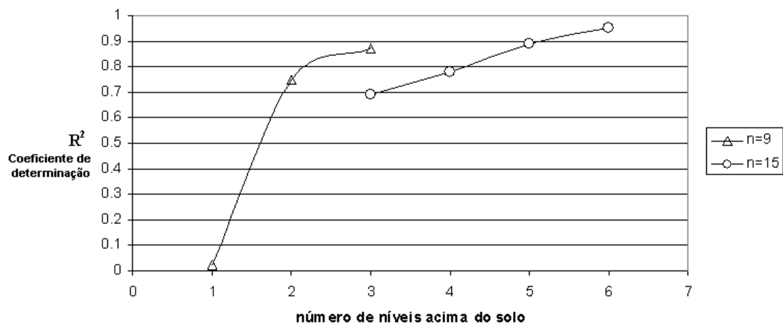
Figura 21. Evolução do coeficiente de determinação R^2 da regressão múltipla, em função do número de níveis do EM38 acima da superfície do solo, para a camada 0-0,3 m.
