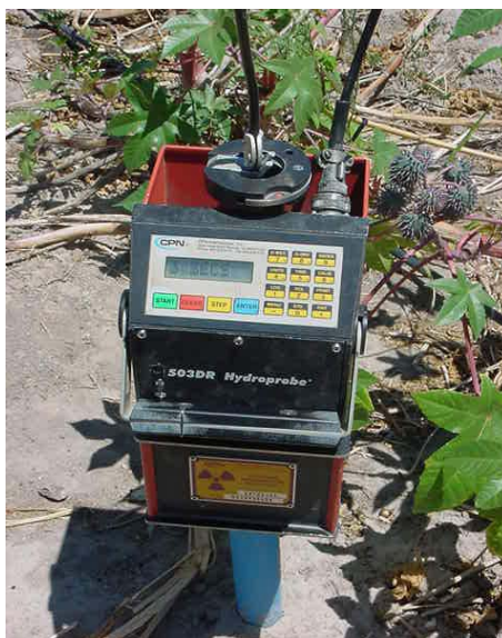
Figura 6. Sonda de Nêutrons no momento da leitura no campo. Pesqueira-PE, 2007.
