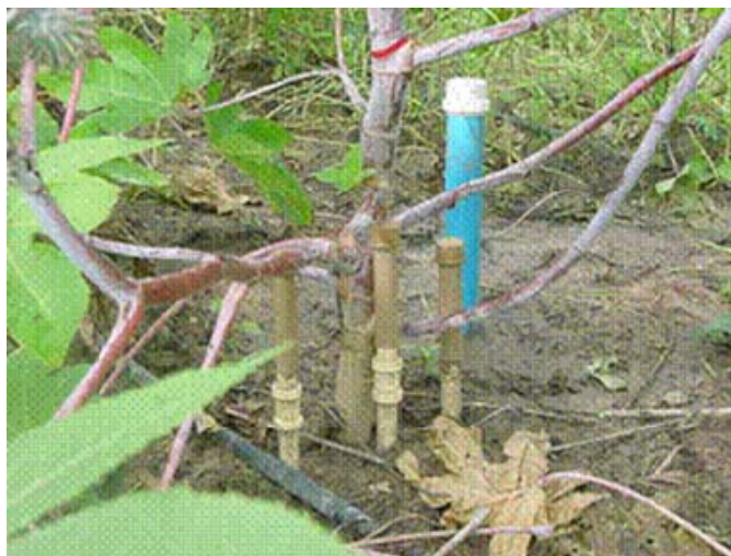
Figura 7. Estação tensiométrica junto com tubo de acesso para Sonda de Nêutrons. Pesqueira-PE, 2007.
