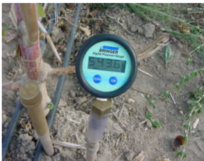
Figura 5. Tensímetro de punção em campo. Pesqueira-PE, 2007
