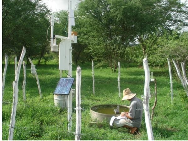
Figura 2 – Vista do Tanque “Classe A” e Estação Climatológica Compacta
