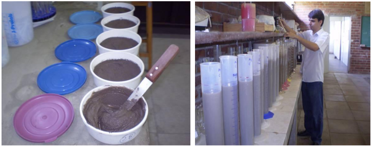
Figura 06. Preparo da pasta de saturação das amostras de solos e análise do grau de floculação após aplicação dos níveis da necessidade de gesso
