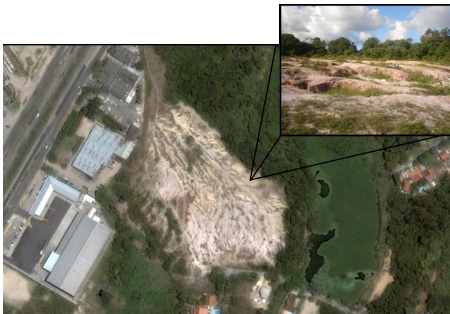
Figura 04. Área de desmatamento, seguido de processo erosivo, localizada próxima ao Açude de Apipucos (Fonte: Google Earth, 2008).
