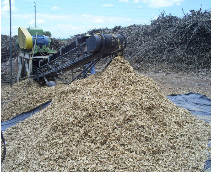
Figura 7: Lenha picada em forma de cavacos para ser utilizada nos fornos.
