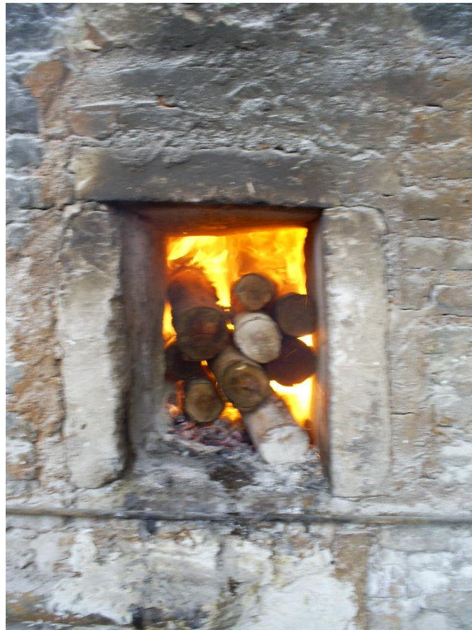
Figura 6: Forno abastecido por lenha em toras para a calcinação da gipsita.
