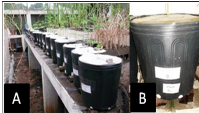
Figura 14 - Visão geral dos ensaios de Moringa oleifera Lam. (A) e estrutura do vaso para a coleta do drenado (B).
