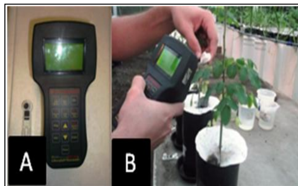
Figura 9 - Determinação da eficiência quântica do PS II. Fluorômetro (A) e utilização do equipamento (B) em mudas de Moringa oleifera Lam. submetidas ao estresse hídrico.
