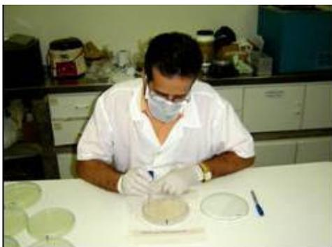
Figura 3 - Perfuração do gel, utilizando-se um tri-perfurador padronizado
