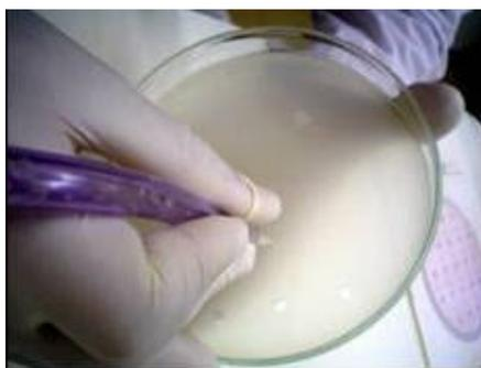
Figura 5 Após perfuração, o gel que fica nos poços são retirados através de um motor de sucção.
