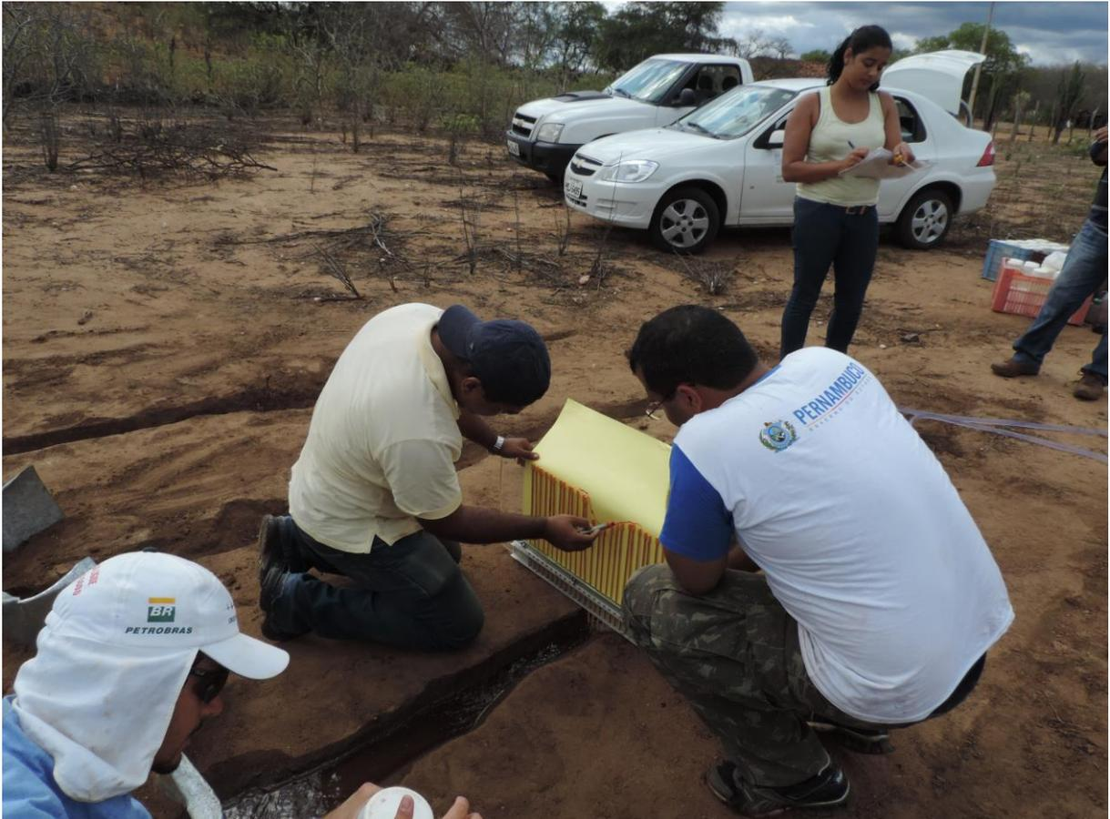
**Figura 7.** Aspecto do levantamento da geometria dos sulcos pré-formados sobre o Neossolo Flúvico, com o uso do perfilometro para determinação da área e perímetro molhado dos mesmos.
