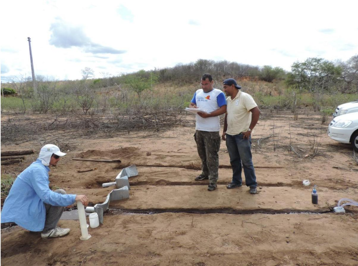
**Figura 6.** Aspecto dos sulcos pré-formados no Neossolo Flúvico, no momento de aplicação de fluxo na cabeceira do mesmo com o auxílio do dissipador de energia.
