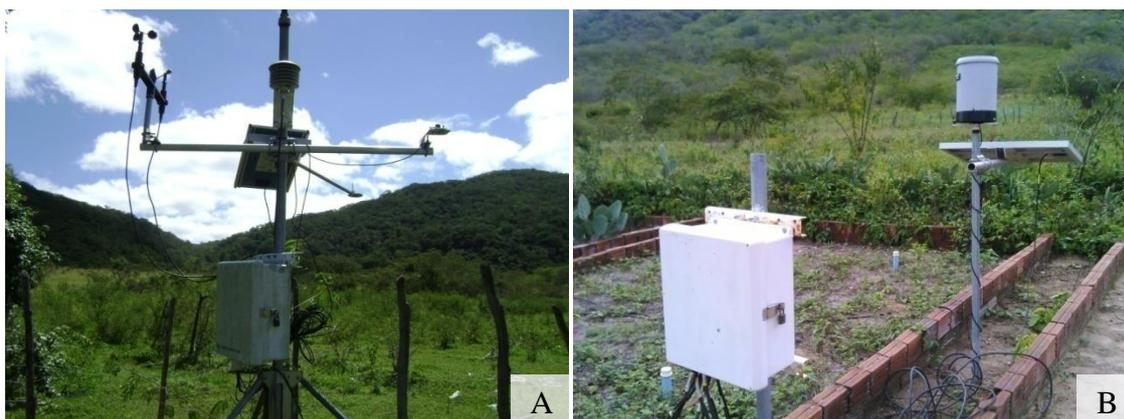
**Figura 5.** Vista da instrumentação utilizada para monitoramento das variáveis meteorológicas, (A) estação climatológica; (B) pluviômetro automático
