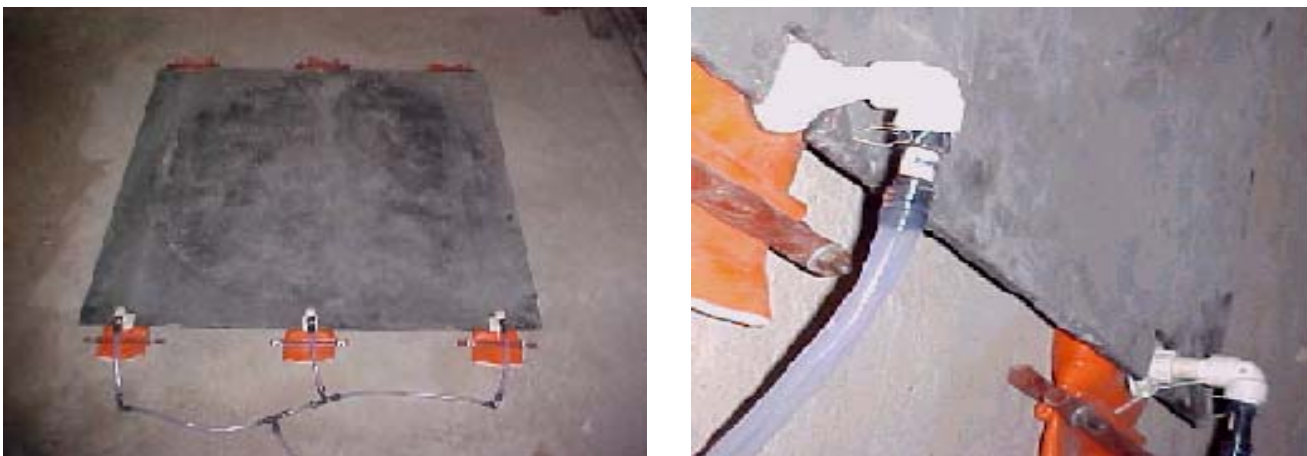
Figura 6. Chapa metálica montada sobre os traveseiros hidráulicos (esq.); Encaixes das conexões dos traveseiros na chapa (dir.)
