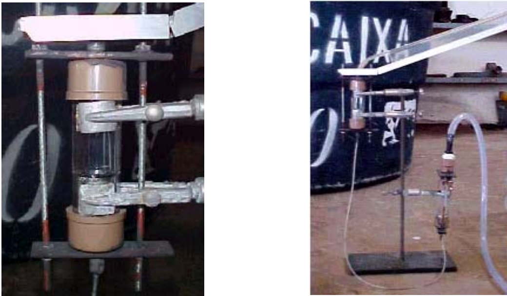
Figura 9. Tubo do pistão montado (esq.); Arranjo de pistão de mercúrio e manômetro (dir.).
