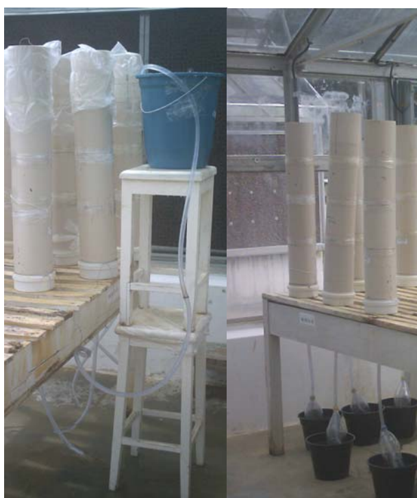
Figura 2. Saturação das colunas por ascensão da água e coleta do lixiviado
