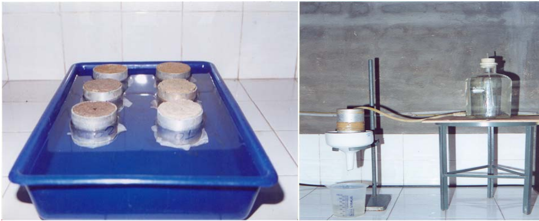
Figura 6. Saturação de amostras de solo e permeâmetro de carga constante.
