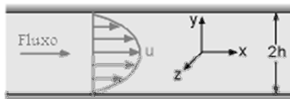
Figura 4.7: Perfil da velocidade para fluxo laminar entre duas placas planas infinitas.
