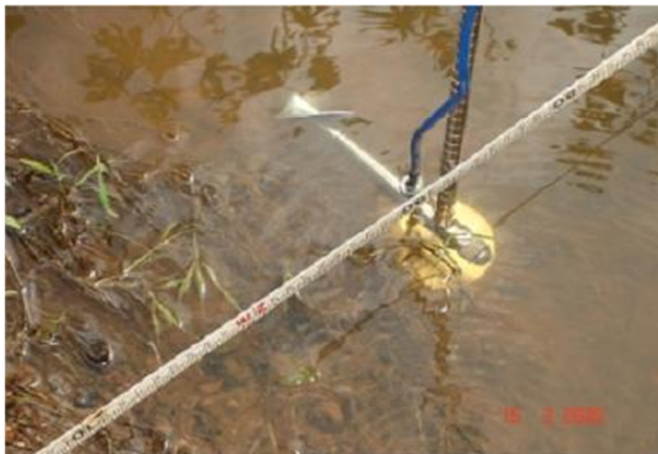
Figura 4.3: Micro molinete utilizado em [19] na medição de velocidades no riacho Exu na manhã de 14/04/2008.
