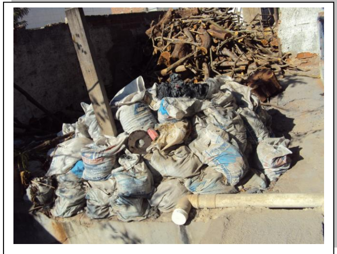
Figura 06 – Sacas resíduo sólido: lodo resultante do processo de lavagem. Fonte: Registro do autor, 2010.
