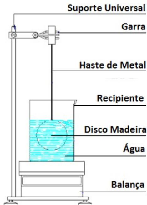
Figura 4: Esquema para determinação do volume verde em discos de madeira. Fonte: (NBR11941, 2003).
