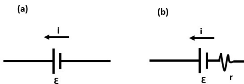
Figura 7: (a) Gerador ideal, não apresenta perdas internas. (b) Gerador real, apresenta perdas internas. Sua resistência interna é dada por r e a força eletromotriz \mathcal{E} é maior que a tensão externa entregue a um circuito. Fonte: Autor.
