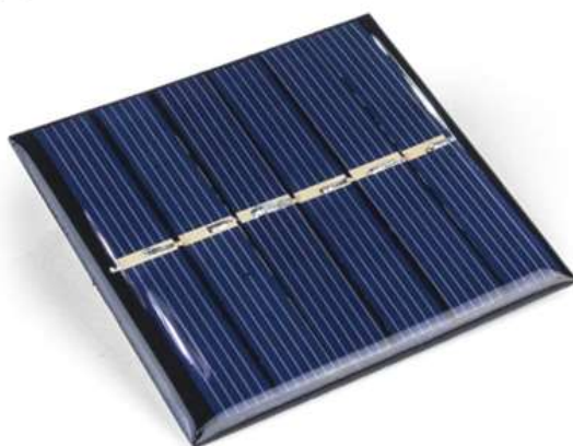
Figura 21: Minicélula solar comercial usada na aplicação do Produto desta dissertação. (a) Visão superior. (b) Visão inferior. Especificações: dimensões de 60 mm x 55 mm x 2,7 mm e peso de 11 gramas. Potência máxima 0,36 W e tensão nominal máxima 3 volts.
