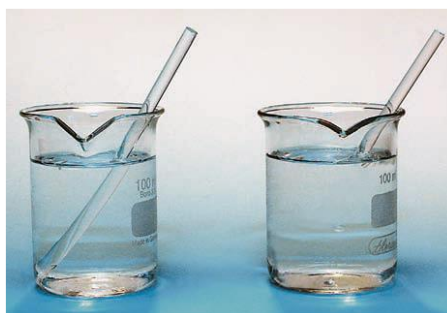
Figura 2: Exemplo de continuidade óptica
