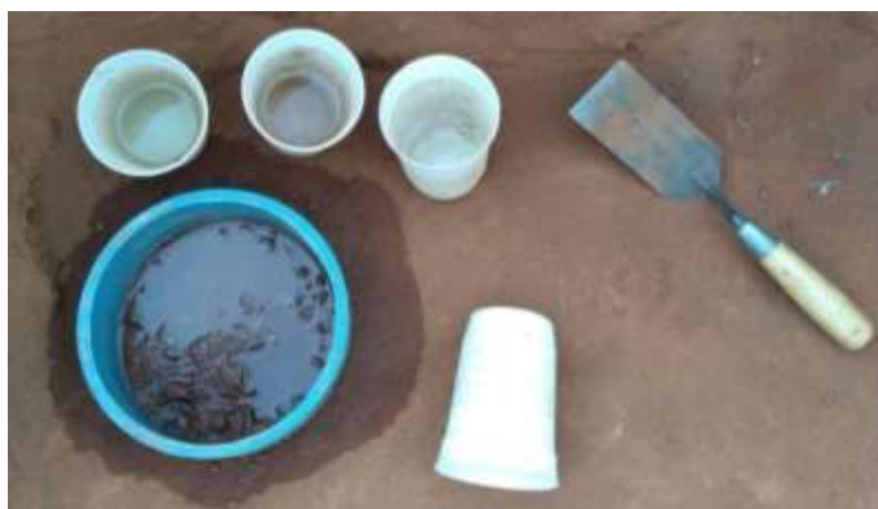
Figura 2. Ensaio de infiltração com anel simples. Fonte: Própria, 2019.
