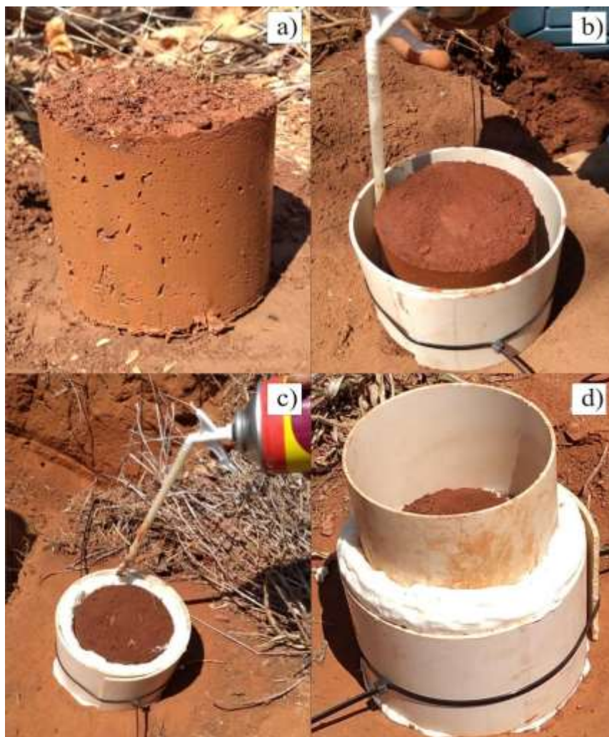
Figura 7. Coleta do monólito cilíndrico (a), aplicação da espuma de poliuretano em molde de PVC (b e c) e estrutura de PVC que acondiciona a carga hidráulica (d). Fonte: Própria, 2019.
