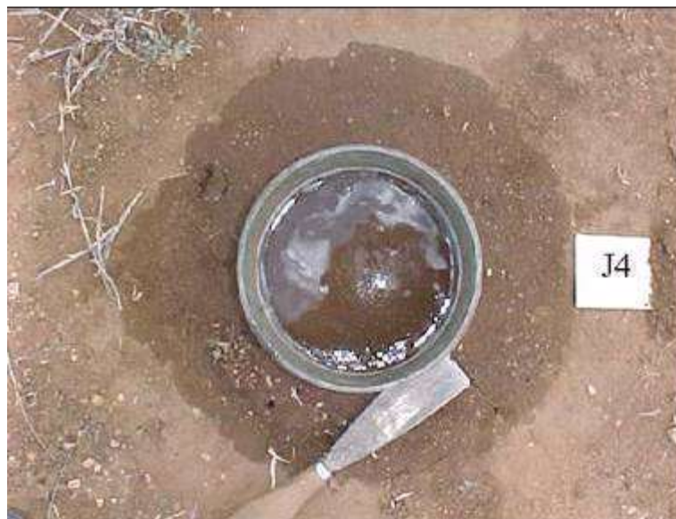
Figura I. Teste de infiltração tridimensional com infiltrômetro de anel (150 mm de diâmetro). Fonte: Souza et al., 2008.
