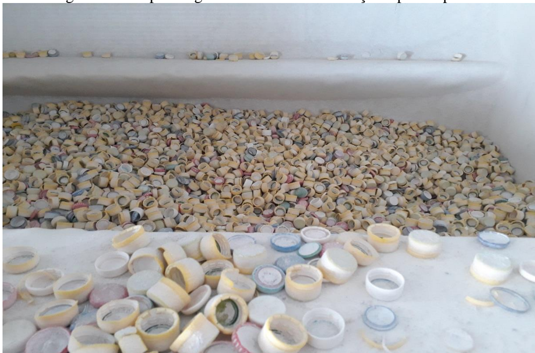
Figura 11-Tampas de garrafas Pets em substituição a pedras pomes.
