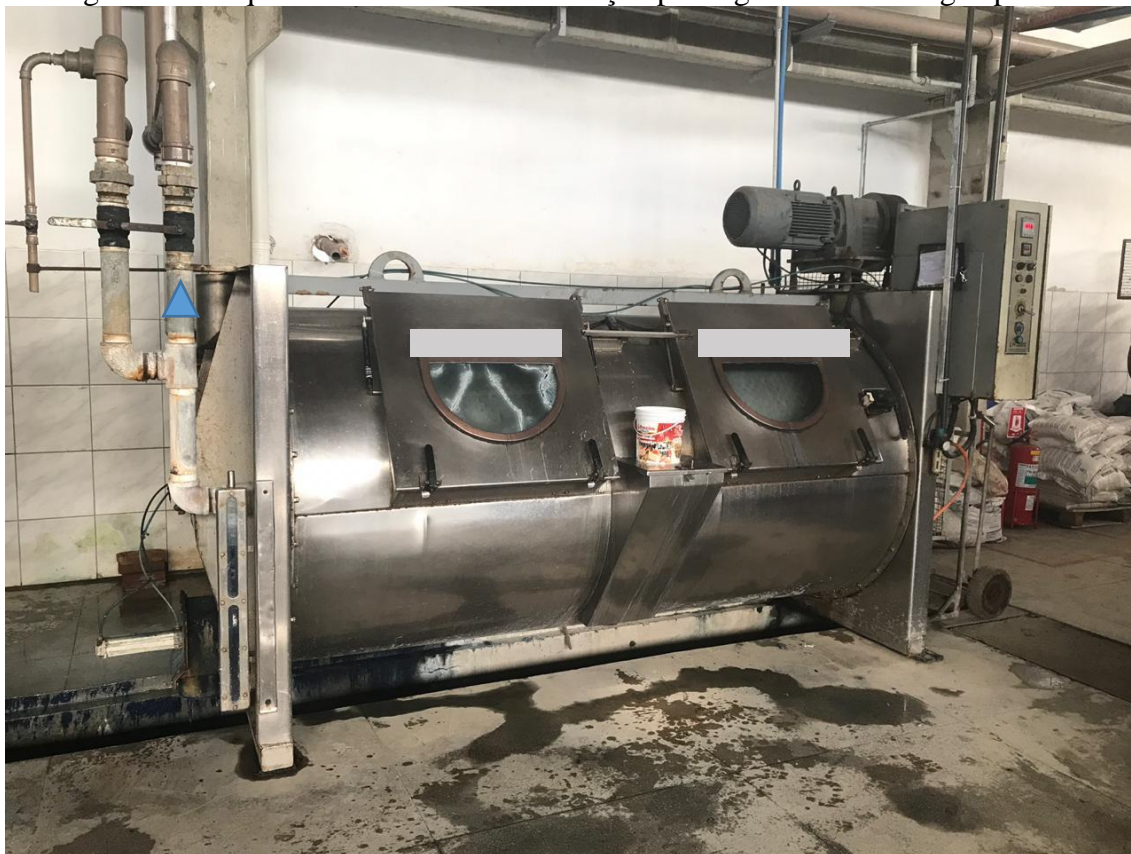
Figura 39. Máquina lavadora com canalização para água de reuso e água potável
