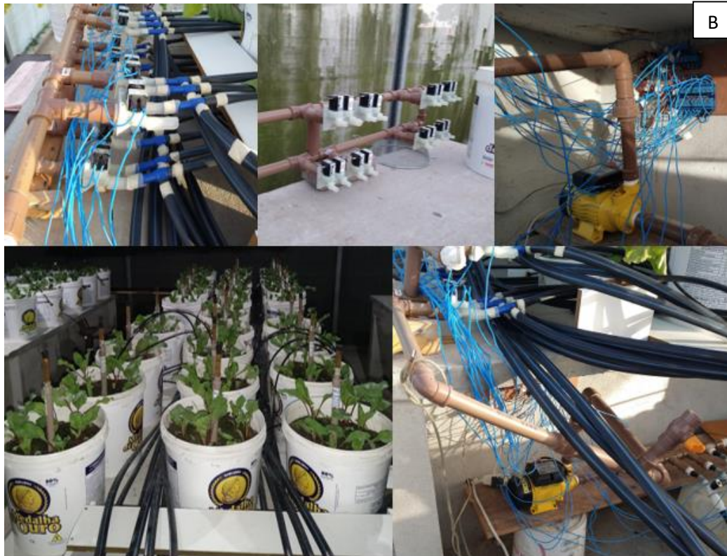
Figura 4. Esquema experimental e do sistema de irrigação (A) e composição de fotos do sistema de irrigação (B).
