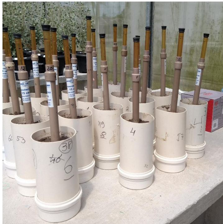
Figura 3. Colunas de solo com tensiômetros instalados.
