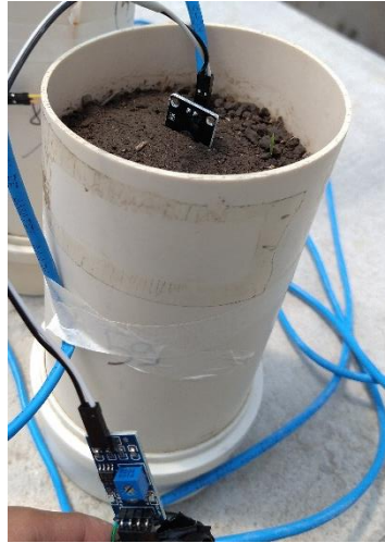
Figura 2. Coluna de solo com sensor YL-69 instalado.
