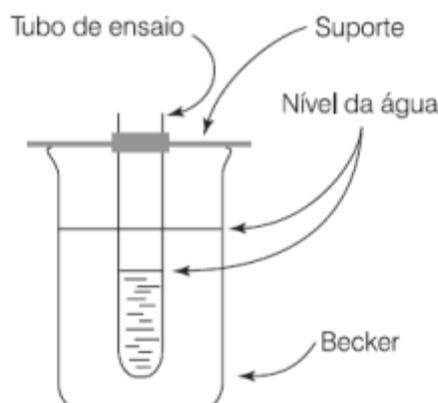
**Figura 2** – Esquema do sistema de aquecimento de água
