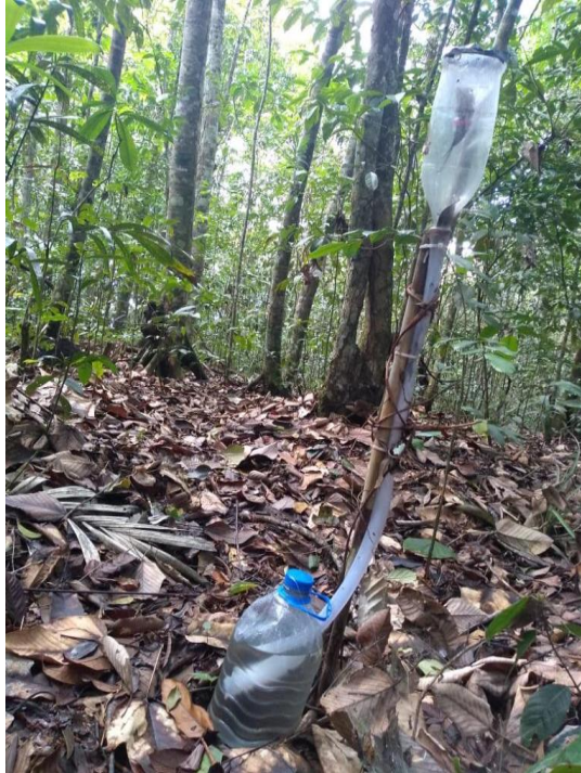
Figura 3. Interceptômetro instalado para captação da precipitação total e precipitação interna no fragmento de Floresta Ombrófila Densa das Terras Baixas, em Sirinhaém, Pernambuco, Brasil.
