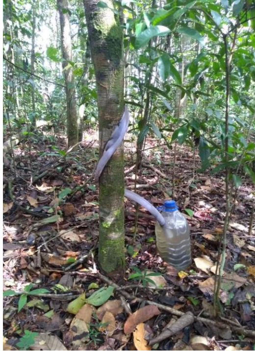
Figura 4. Sistema coletor utilizado para captar o escoamento pelo tronco das espécies florestais no fragmento de Floresta Ombrófila Densa das Terras Baixas, em Sirinhaém, Pernambuco, Brasil.
