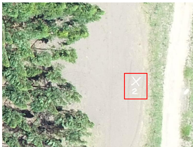
Figura 8 – Exemplo dos alvos terrestres inserido no solo no plantio experimental de eucalipto do Campus de Engenharias e Ciências Agrárias da Universidade Federal de Alagoas.
