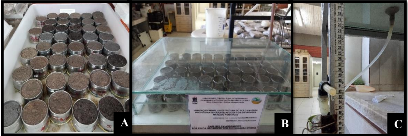
Figura 6. Amostras em saturação (A); amostras na mesa de tensão (B); amostras submetidas a tensão de 3Kpa (C)
