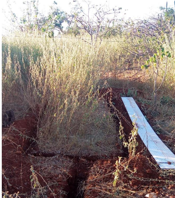
Figura 05. Abertura de sulcos no solo para instalação das parcelas experimentais. (Fonte: Cíntia Lins, 2019)
