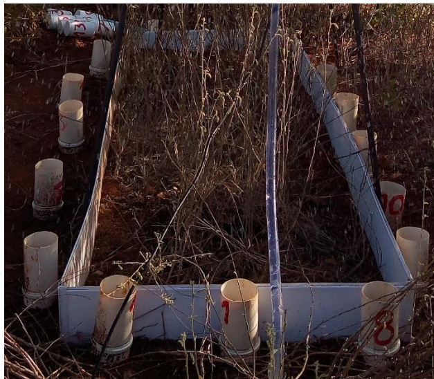
Figura 06. Disposição dos pluviômetros em torno da parcela experimental. (Fonte: Cíntia Lins, 2019)
