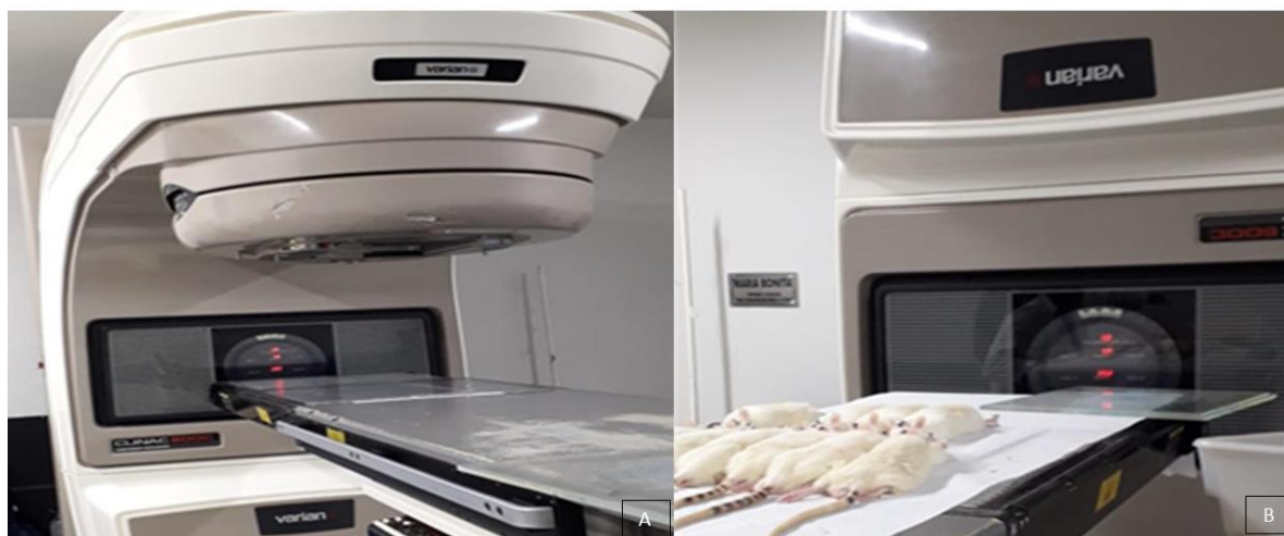
Figura 2. Acelerador linear Varian, modelo Clinac 600C (A), com os animais anestesiados e posicionados em decúbito dorso-ventral para irradiação da região de cabeça e pescoço (B). (Fonte: arquivo pessoal).
