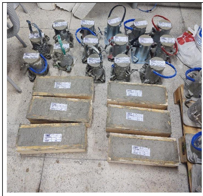
Figura 12 – Corpos de prova moldados.
