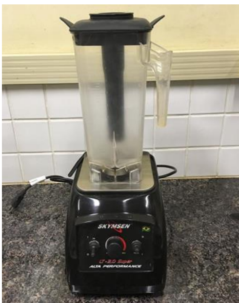
Figura 14 - Liquidificador industrial com hélices de titânio.
