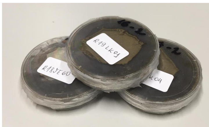
Figura 15 - Amostras encapsuladas e seladas para a quantificação de radionuclídeos naturais por EGAR.
