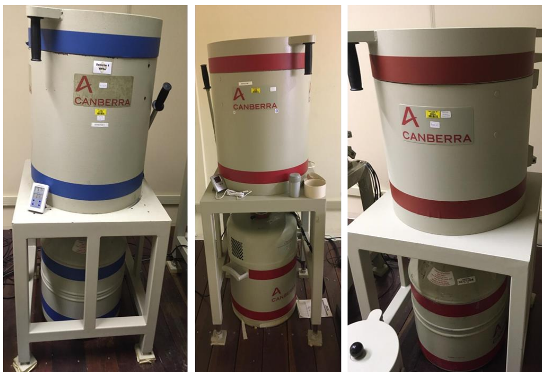
Figura 16 – Blindagens dos detectores de Germânio Hiperpuro (HPGe) da Canberra.
