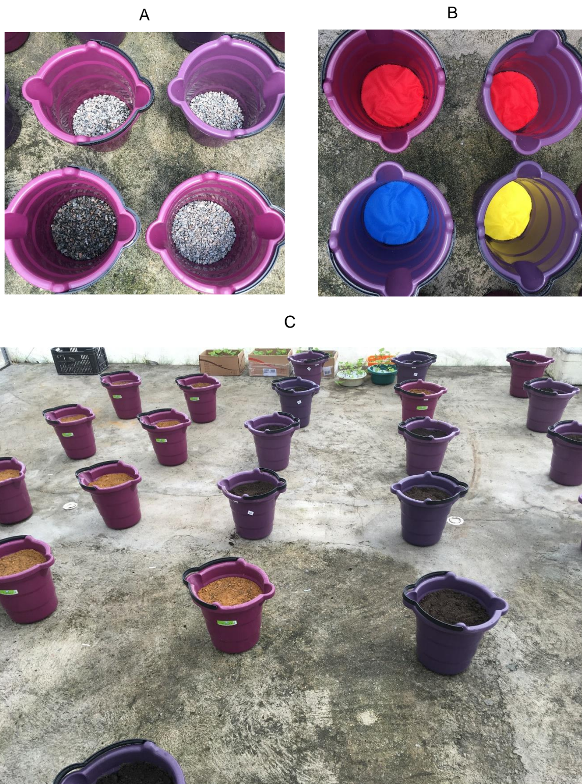
Figura 10 - Passo a passo da preparação dos vasos: A) Camada de brita; B) Feltro; C) Preenchimento com solo.
