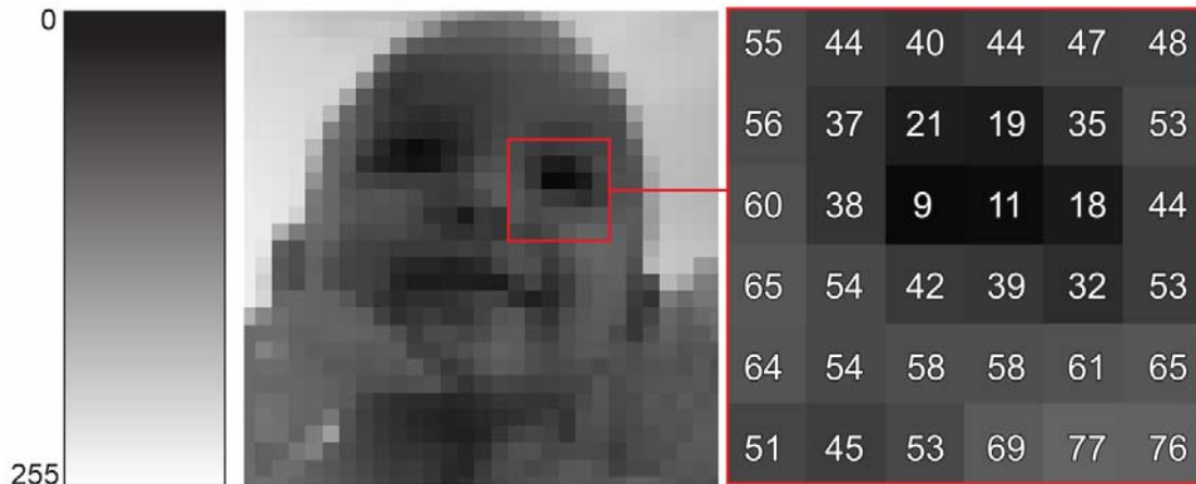
Figura 9 – Variação da intensidade e valores dos pixels em imagem de tons de cinza
