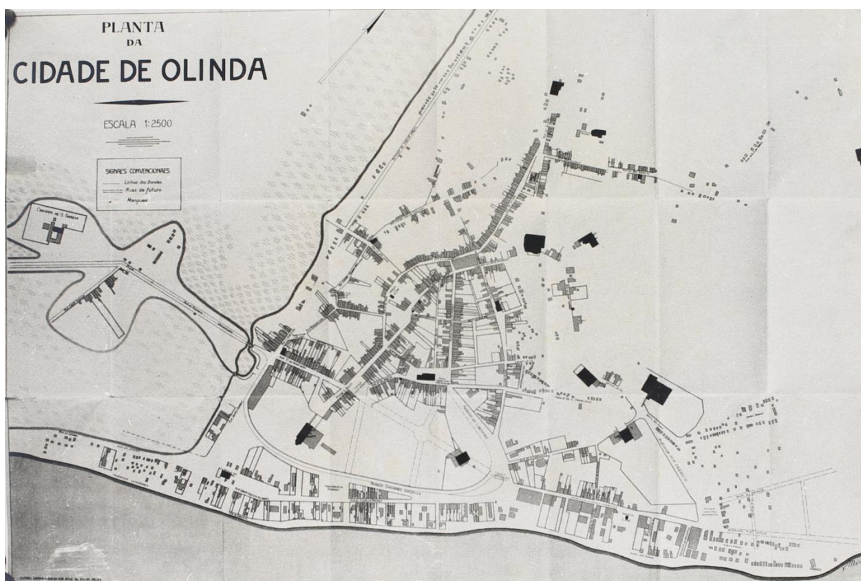
Figura 2 – Planta executada a mando do Coronel Arthur Lundgren, 1915, e modificada em 1924, apresentando o traçado para as linhas do bonde (traçado único) e arruamentos futuros, sobretudo no Carmo e Varadouro, paralelas à Avenida Sigismundo Gonçalves (traçado duplo). Fonte: Acervo Digital IPHAN, (ACI-RJ).
