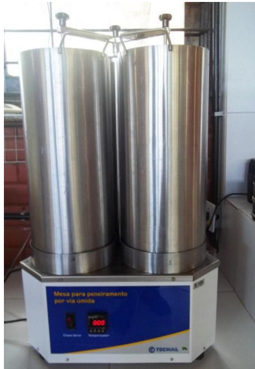
Figura 9 - Aparelho de oscilação vertical do tipo Yooder para realização do teste de estabilidade de agregados via úmida
