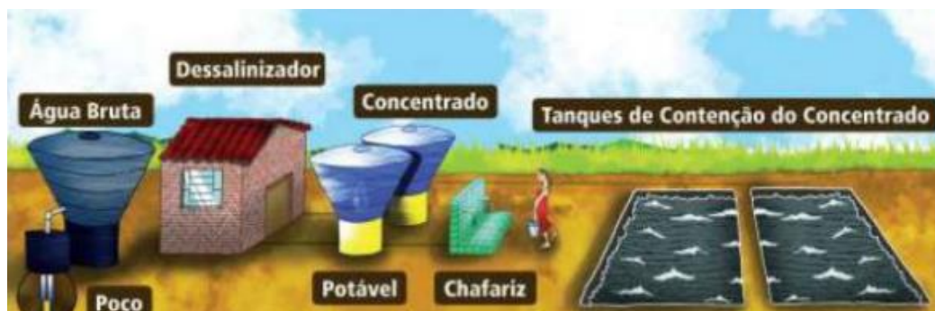
Figura 26 – Esquema do Sistema de dessalinização adotado pela PAD
