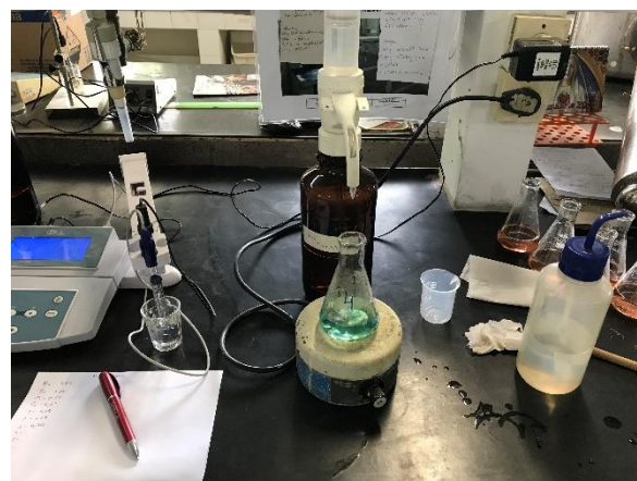
Figura 12– Titulação da amônia após destilação do extrato das amostras de solo no laboratório de fertilidade do solo/UFPE.
