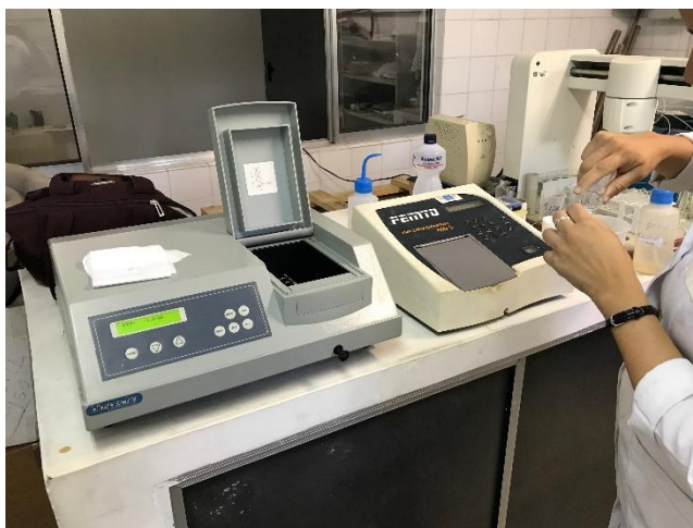
Figura 16 - Determinação dos teores de C na água em espectrofotômetro, no laboratório de fertilidade do solo/UFPE.
