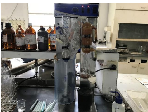
Figura 11– Destilação do extrato das amostras de solo no laboratório de fertilidade do solo/UFPE.
