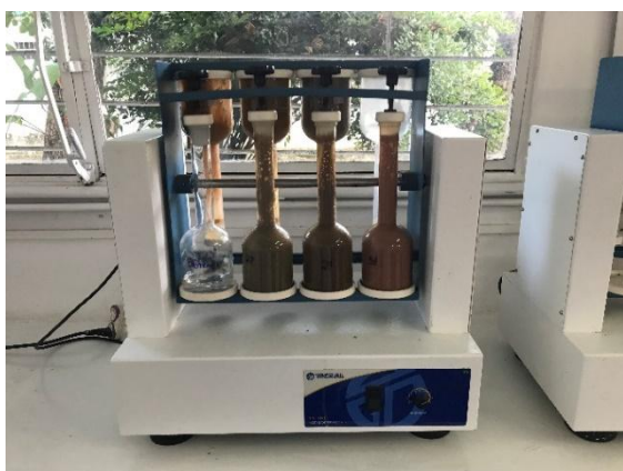
Figura 9 - Agitação de solução em Agitador tipo Wagner no laboratório de fertilidade do solo/UFPE.
