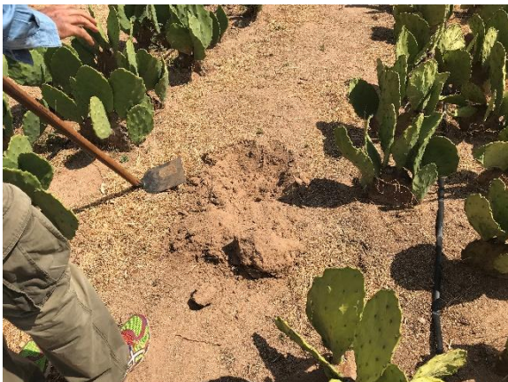
Figura 8 - Coleta de amostras de solo pelo método do anel volumétrico na área de agricultura de tomate irrigada com água superficial em Santana do Seridó/RN.
