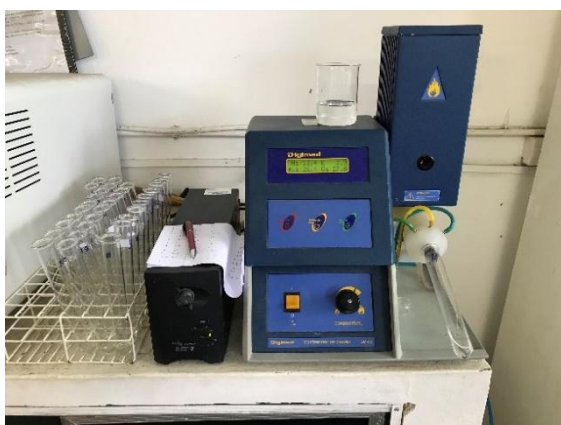
Figura 13 - Análise dos teores de Na e K em fotômetro de chama, no laboratório de fertilidade do solo/UFPE.
