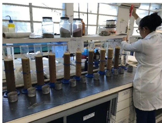
Figura 10 - Coleta de silte+argila das amostras de solo no laboratório de fertilidade do solo/UFPE.
