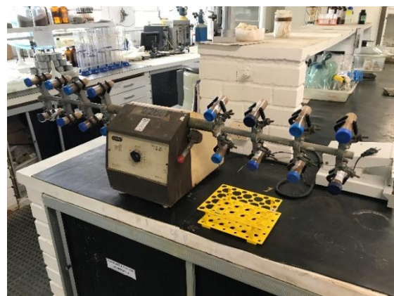
Figura 14- Agitação dos extratos das amostras pelo método Mehlich1, no laboratório de fertilidade do solo/UFPE.
