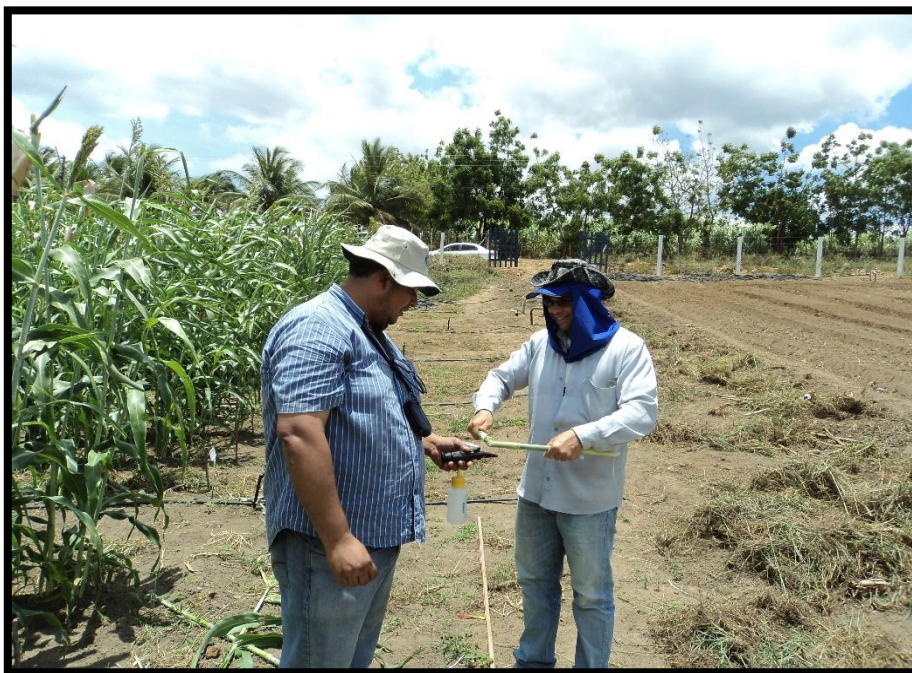
Leitura do teor de sólidos solúveis do colmo com refratômetro
