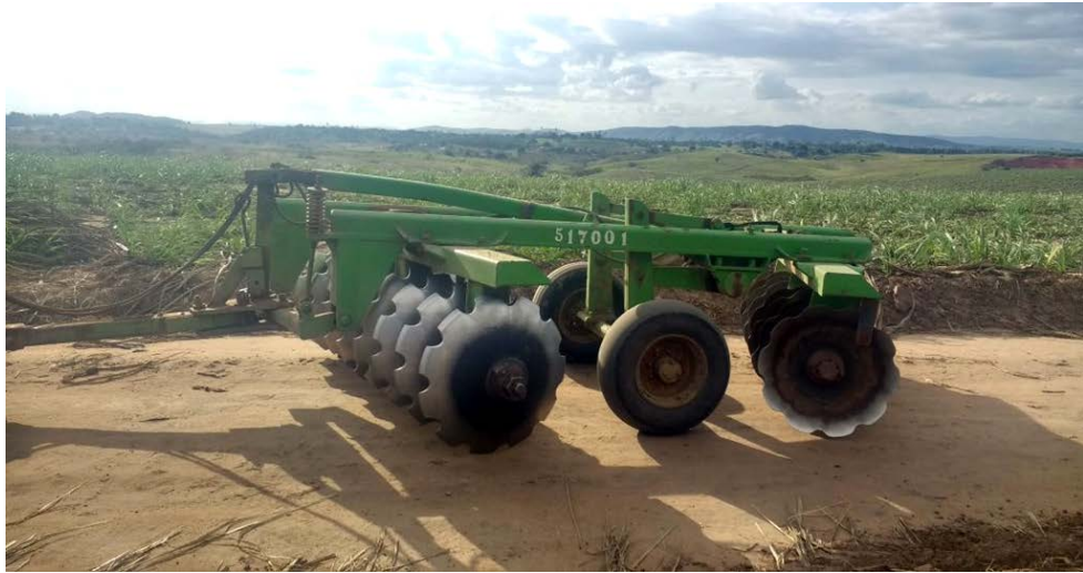
Figura 12 – Grade aradora pesada utilizada na operação revolvimento nas áreas 01 e 02, durante a coleta de dados
