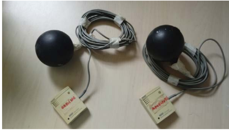
Figura 16 – Equipamentos HOBO U12-12 utilizados nos registros das variáveis temperatura do ar (°C), umidade relativa do ar (%) e temperatura de globo negro, nos tratores sem e com cabine (áreas 01 e 02) e no ambiente externo
