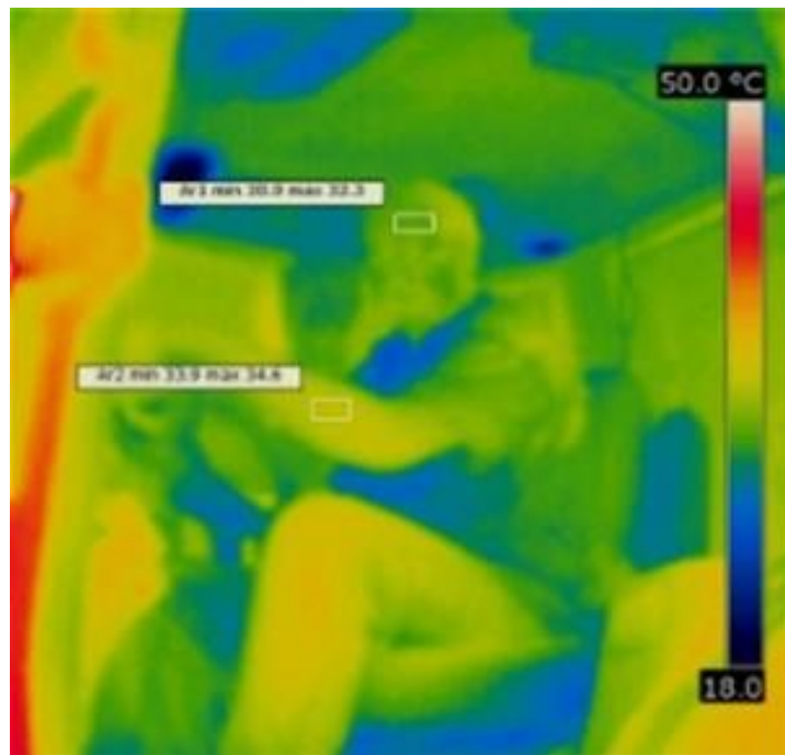
Figura 26 – Imagem termográfica do operador na plataforma de trabalho e identificação da temperatura média de braço (32,3°C) e da cabeça (34,4°C).
