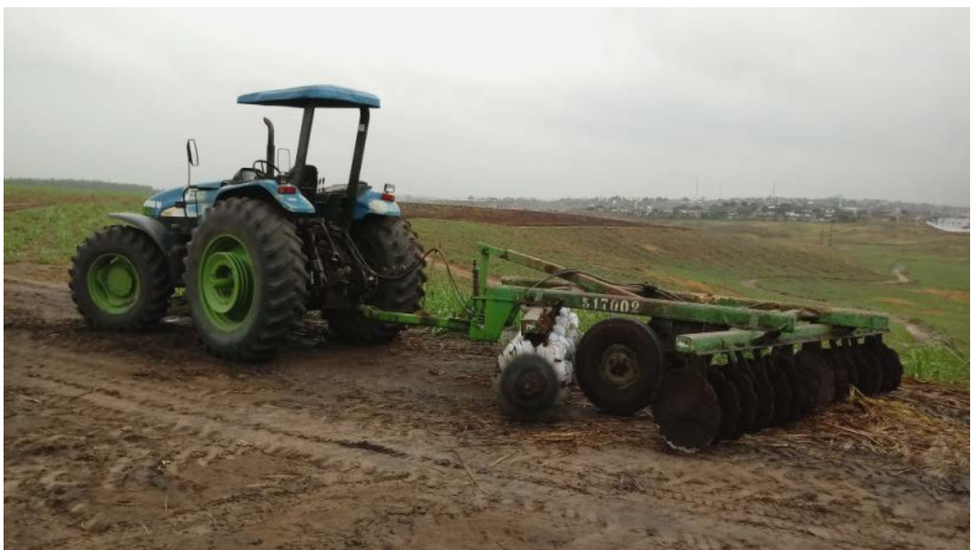
Figura 13 – Grade destorroadora/niveladora média utilizada nas áreas (01) e (02), durante a coleta de dados na operação de gradagem
