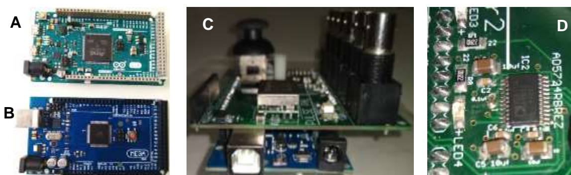
Figura 3: Alterações no projeto “Pulse Pal”. Apresentamos em (A) o Arduino Due, (B) Arduino Mega, (C) conexão entre arduino e placa de circuito impresso “PULSE PAL” e (D) o novo DAC.
