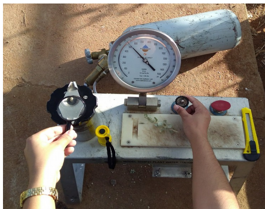
Figura 6. Determinação do potencial hídrico foliar ( \Psi_h ) das plantas de Erva-sal ( Atriplex nummularia L.) com auxílio da câmara de Scholander.
