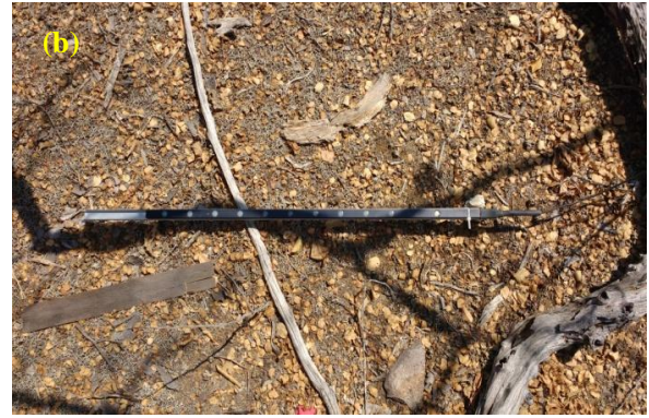
Figura 3.4 - Sensor PAR linear, instalado abaixo do dossel (SQ-321 Calibration Line Quantum Net10 sensors, Apogee, Logan, Utah, USA) próximo às plantas (RFALI, \text{MJ m}^{-2} \text{d}^{-1} ) utilizados na área de caatinga com perturbação antrópica (CPA) durante a estação chuvosa (a) e seca (b).
