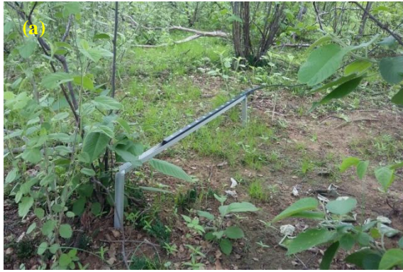
Figura 3.4 - Sensor PAR linear, instalado abaixo do dossel (SQ-321 Calibration Line Quantum Net10 sensors, Apogee, Logan, Utah, USA) próximo às plantas (RFALI, \text{MJ m}^{-2} \text{d}^{-1} ) utilizados na área de caatinga com perturbação antrópica (CPA) durante a estação chuvosa (a) e seca (b).
