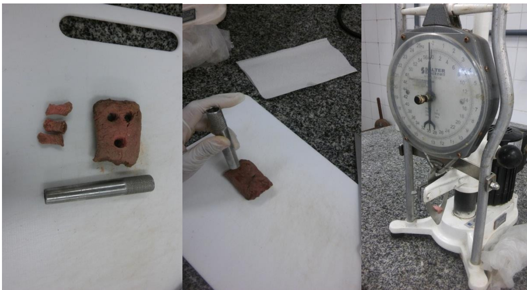
Fig 11. Retiradas de feixes cilíndricos e amostra no equipamento Warner-Bratzler-Shear® para obtenção da força de cisalhamento da carne
