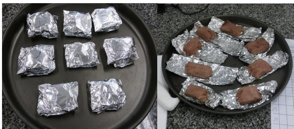
Fig. 10. Amostras embaladas e posteriormente assadas a 71°C para realização da PPC
