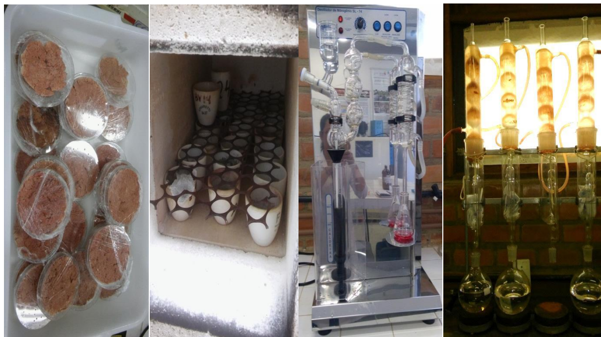
Fig. 13. Amostras de carne liofilizadas e análises de material mineral, proteínas e extrato etéreo
