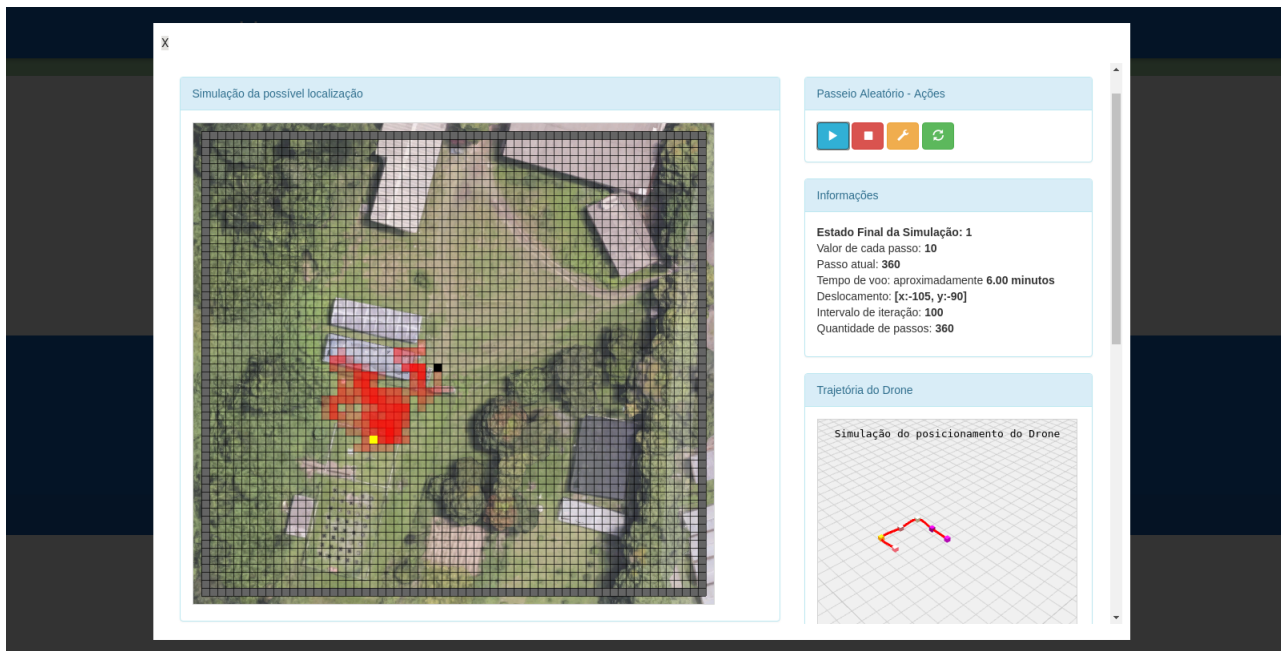
Figura 4.20: Imagem mostra uma simulação de 360 passos aleatórios em um ambiente - Fonte: elaborado pelo autor
