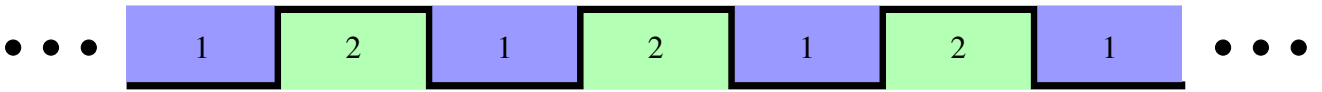
Figura 3.1 Representação esquemática de uma super-rede na banda de valência para dois tipos diferentes de materiais, 1 e 2.
